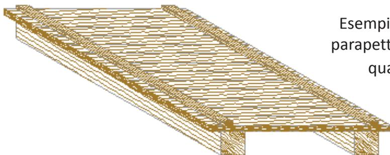
Esempio di passerella senza parapetto con travi a sezione quadrata e fermapiede.
