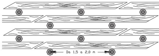
Particolare fissaggio corrente/traverso
