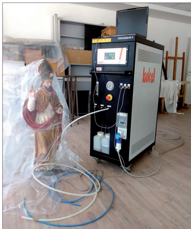
2. Allestimento del sistema anossico applicato ad una statua lignea policroma. (M.P. Longo Cantisano)
