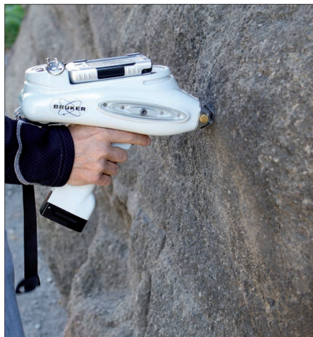
2. Indagini non invasive mediante spettrofotometria di fluorescenza ai raggi X all'arco di Augusto. (N. Odisio)
