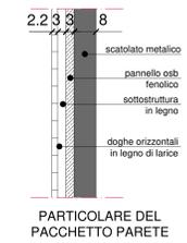
N.B. l'involucro architettonico non interferisce con la struttura in c.a. della cabina elettrica
