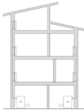
Figura III - Sistema edificio-impianto costituito da una porzione di edificio servita da un generatore autonomo
