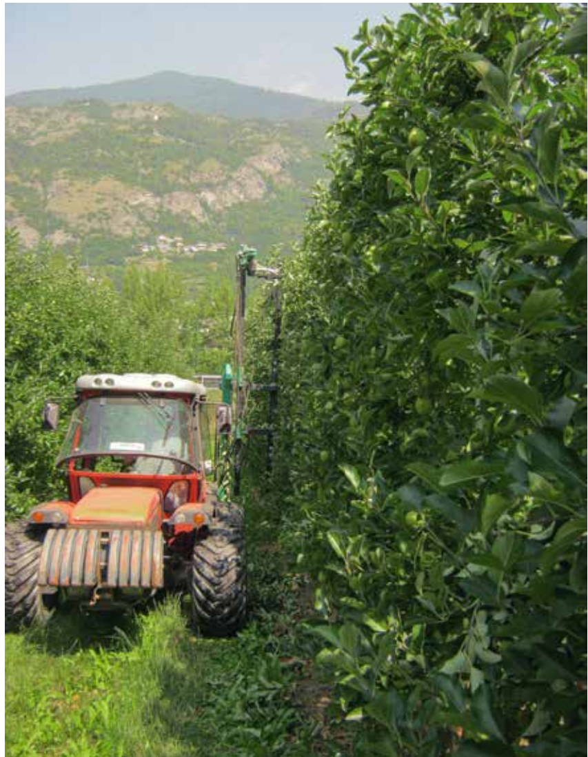
Fig 1. Passaggio della barra per la potatura meccanica
