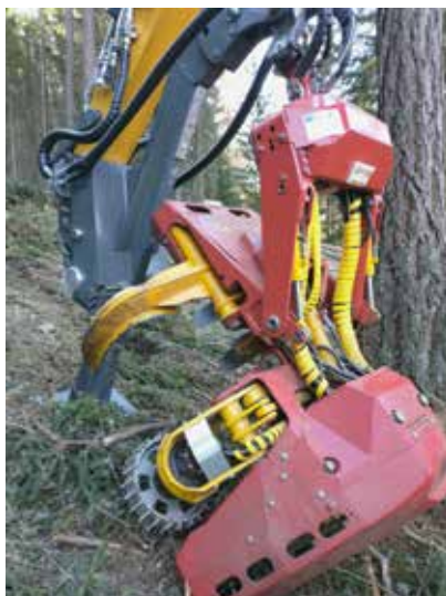
Tête d'abattage multifonctionnelle. Investissement financé par le Programme de développement rural
