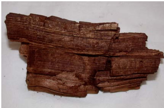
Figura 6.7 Campione di legno con caratteristica carie bruna cubica. Si notano le sfaldature del legno secondo tre piani ortogonali.
