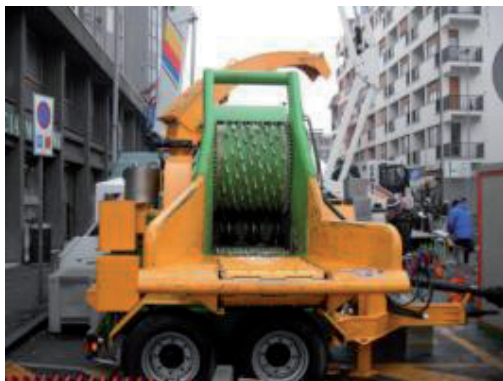
Foto 1 – Cippatrice HM 8-500 k azionata da trattore e impiegata per servizio di cippatura
