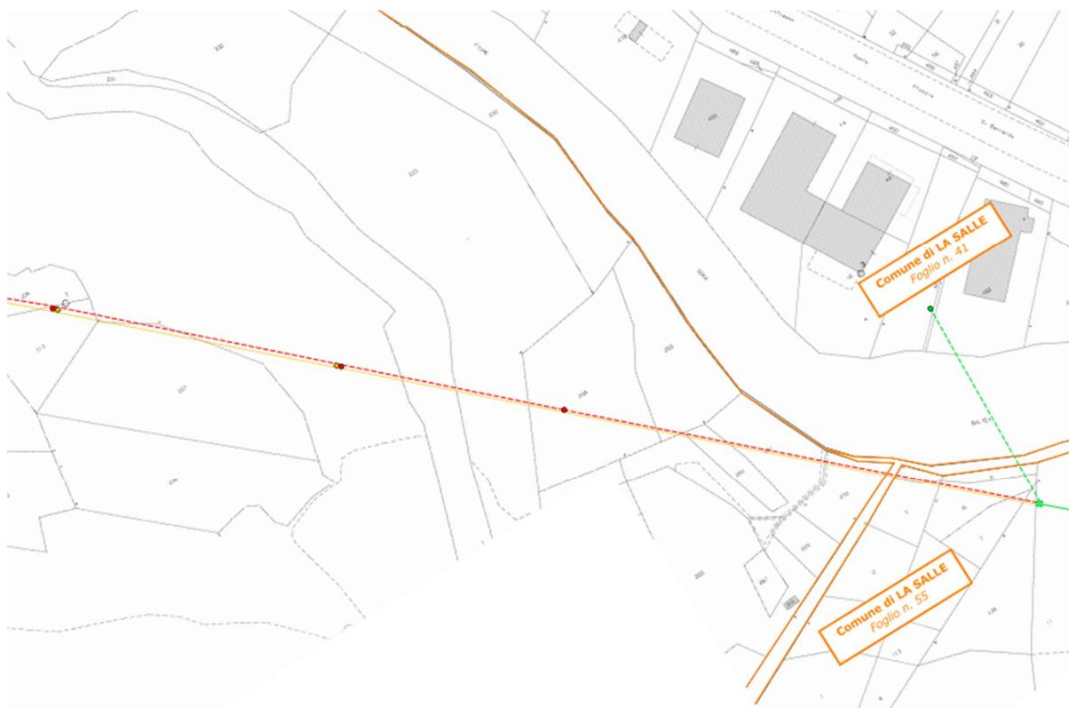
**Figura 9** – Planimetria degli interventi con ubicazione del tratto di valle della linea elettrica, dei sostegni esistenti (verde) ed in progetto (rosso). Come evidenziato dalla planimetria catastale i nuovi sostegni non saranno posati in sponda destra dell'alveo del fiume Dora Baltea.
