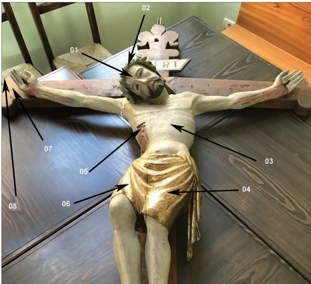
1. Punti di misura XRF effettuati sul Crocifisso. (D. Vaudan)
