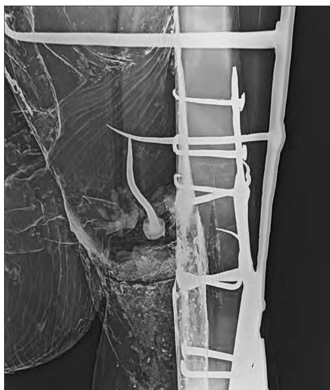
14a.-b. Le radiografie evidenziano gli interventi strutturali eseguiti nel tempo sul verso dell'opera. (N. Cuaz)
