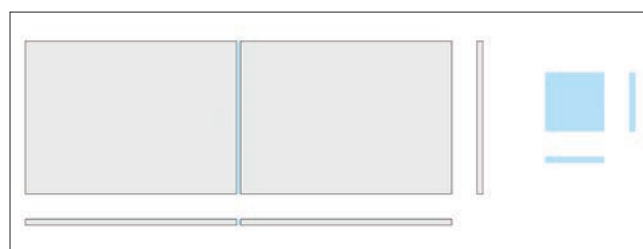
3. Vetrini incollati testa-a-testa per l'esecuzione dei test di resistenza meccanica e campioni di adesivo (10x10x2 mm). Adesivo colore azzurro e vetro colore grigio. (G. Champion)
