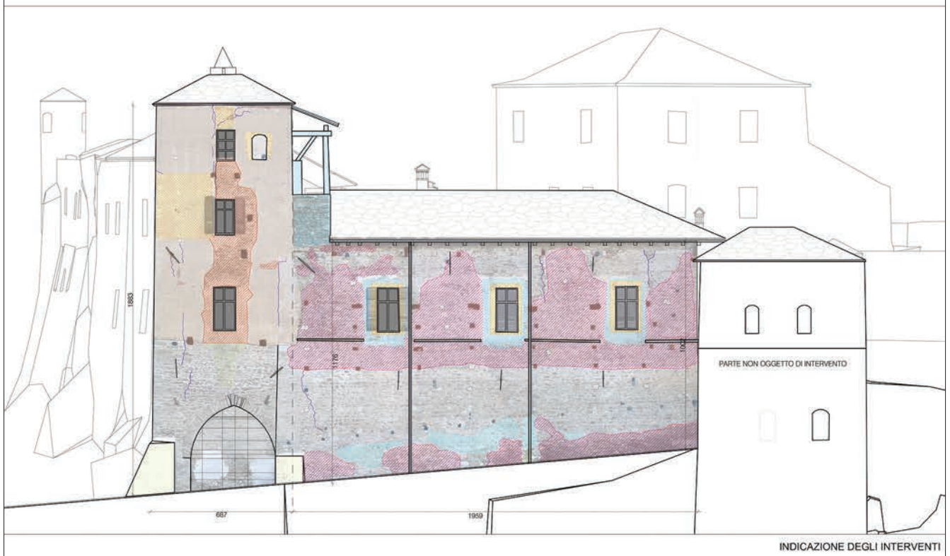
3. Estratto dalla tavola RES4.03. Progetto esecutivo. Prospetto esterno sud-ovest. Mappatura del degrado ed interventi di restauro. (RTP Progetto di restauro e valorizzazione del Castello di Quart II lotto)
