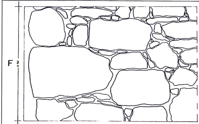
Pierre équarees, angoli arpeggiati, GA= Grand appareil=Grande apparecchio murario.
