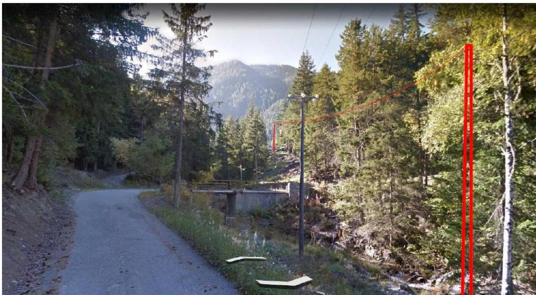
*Tratto da Ponte Veyon a Centrale: Sostituzione conduttori nudi con Cavo 15 kV precordato (Elicord)*
