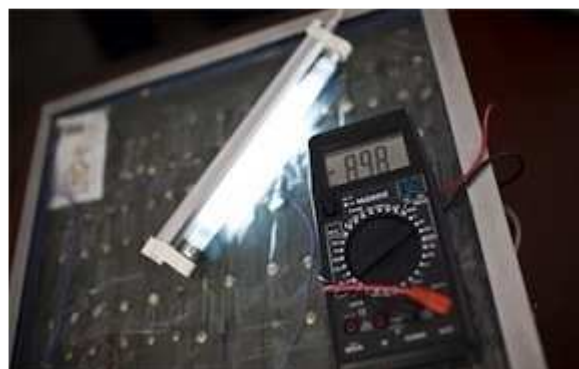
Un multimetro digitale mostra il voltaggio generato dal pannello
