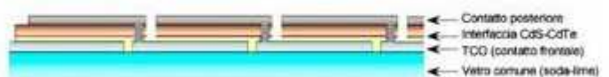
Schema di un modulo, visto in sezione. Notare i 3 tagli degli strati che consentono il collegamento in serie delle varie celle.
