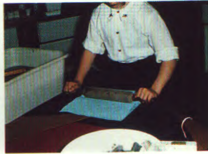
18) après avoir mis une chiffonnette, passer le rouleau - le tamis est déposé dans le bac de rinçage
