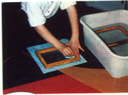
16) essuyer les bords, le grillage en pressant fort (ne pas oublier d'essorer l'éponge)
