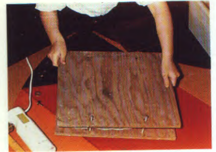
20)... mise sous presse de l'ensemble chiffonnette et feuille
