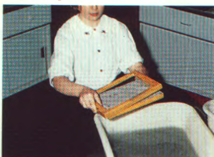
7) notre tamis est en deux parties avec un cadre
