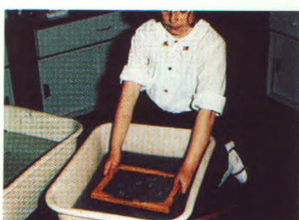
10) le tamis est remonté bien horizontal pour obtenir une épaisseur uniforme
