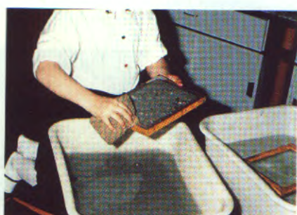
12) le cadre est déposé dans le bac de rinçage-essuyer les bords du tamis avec une éponge
