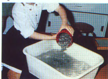
5) la pâte est versée dans le bac rempli d'eau
