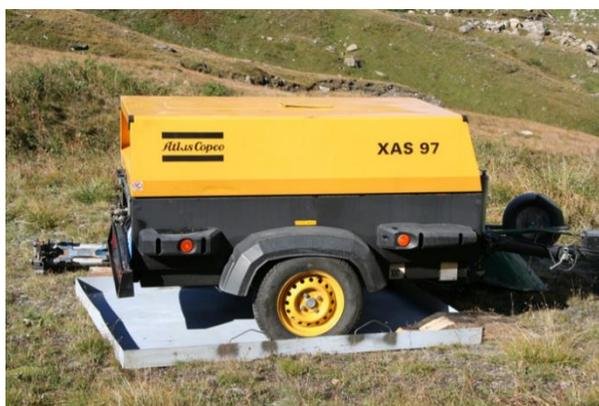
Esempio di compressore installato su telo impermeabile con risvolto laterale per il contenimento di oli
