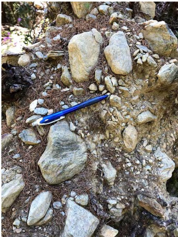
*Figura 13 - Caratteristiche della matrice del deposito, costituita da massi, ciottoli e ghiaia grossolana in frazione fine prevalentemente sabbiosa. Si noti il grado di arrotondamento dei clasti, tipico di un deposito glaciale.*
