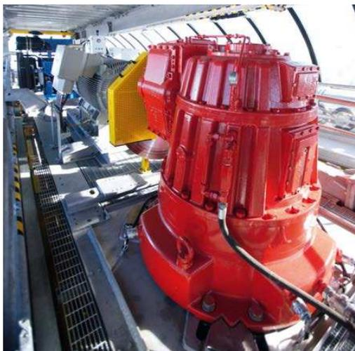
*Figura 2-12 Argano principale tradizionale: motori-disco freno-riduttore epicicloidale-puleggia*
